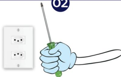
Retire as tampas das tomadas, painéis de tv ou qualquer objeto que atrapalhe a instalação.
