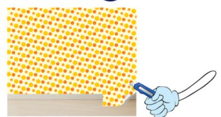
Após fixar o adesivo em toda superfície, utilize a régua e o estilete para dar o acabamento, cortando todas as sobras. Para terminar passe a espátula marcando os buracos das tomadas e recorte envolta com cuidado, tire esse adesivo e recoloca as tampas das tomadas. E PRONTO!
