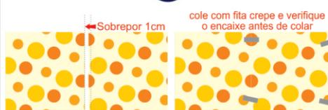
Pegue o próximo rolo, seguindo as numerações. Sobreponha 1cm e prenda com fita crepe em uma distância de 50cm (mais ou menos) até embaixo e verificando o encaixe das imagens. Conforme for fixando o adesivo retire as fitas. Faça o mesmo procedimento com os próximos rolos até cobrir toda a superfície.
