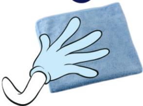
Limpe a superfície com o pano macio, passando por toda a área a ser adesivada, lembrando que a parede deve estar livre de infiltrações, rachaduras ou mofo.
